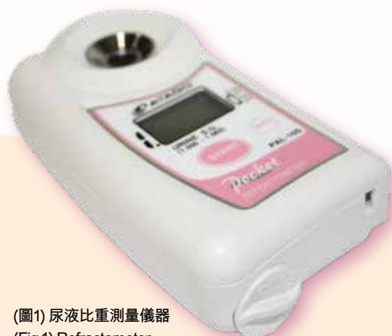
(圖1) 尿液比重測量儀器
